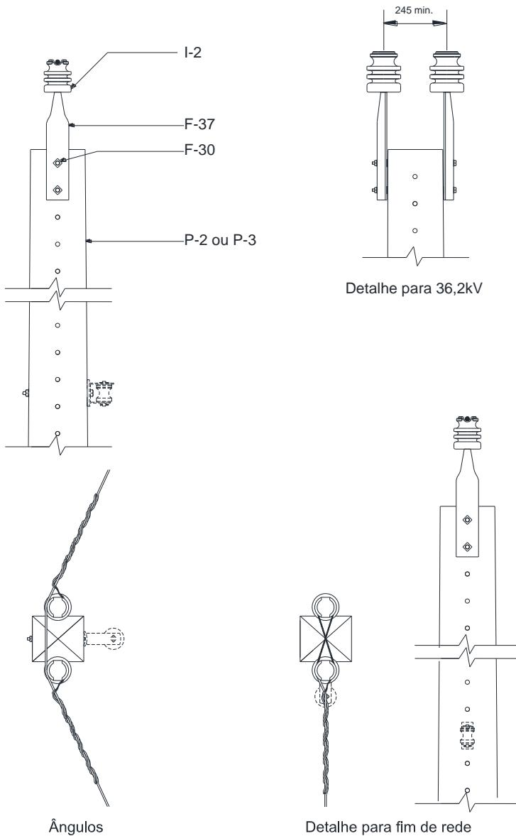
Figura 31 – Estrutura U2 – Poste de concreto de DT ou de madeira
