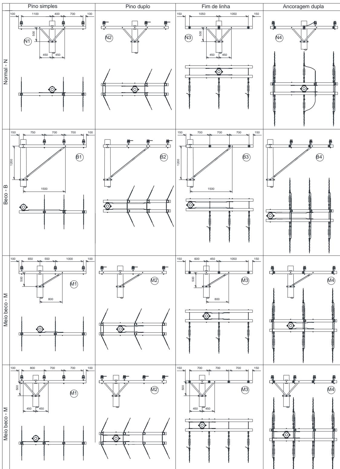
Figura 24 – Afastamentos de condutores – Cruzeta de 2400mm
