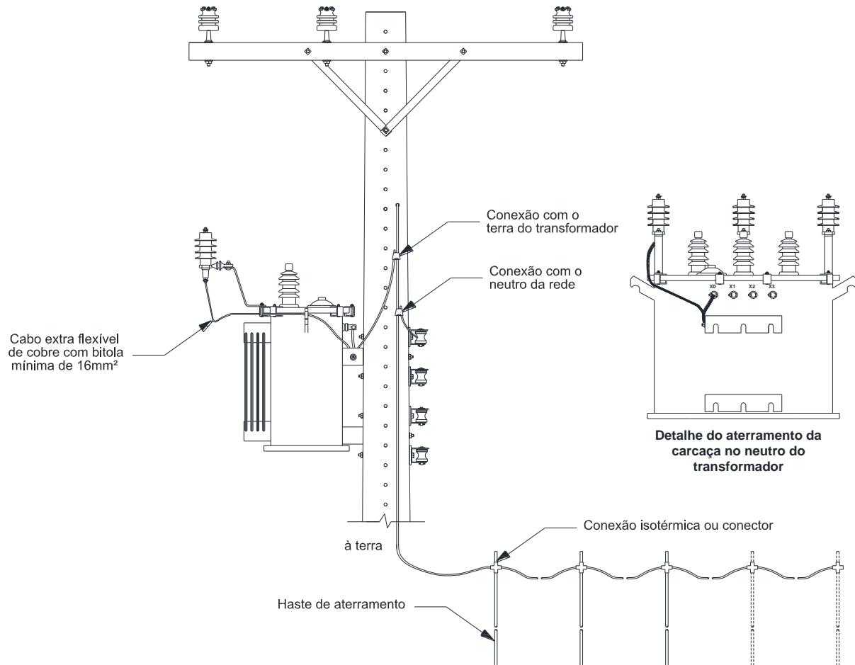
Figura 143 – Aterramento de equipamento – Alternativa
