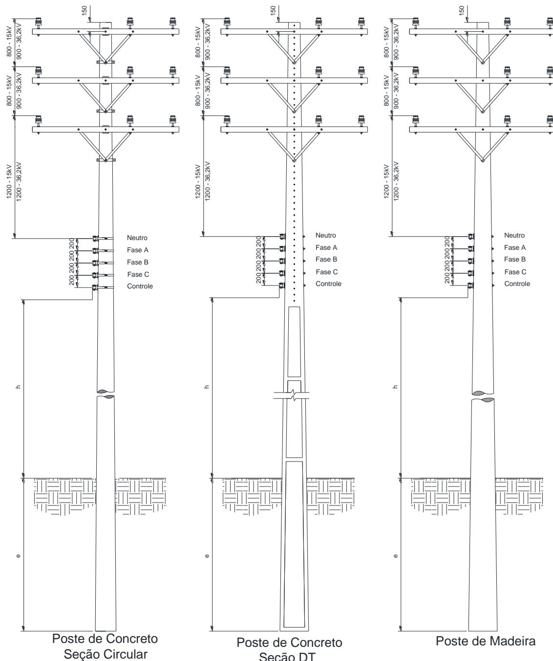
Figura 14 – Afastamentos mínimos – Estruturas trifásicas tangentes
