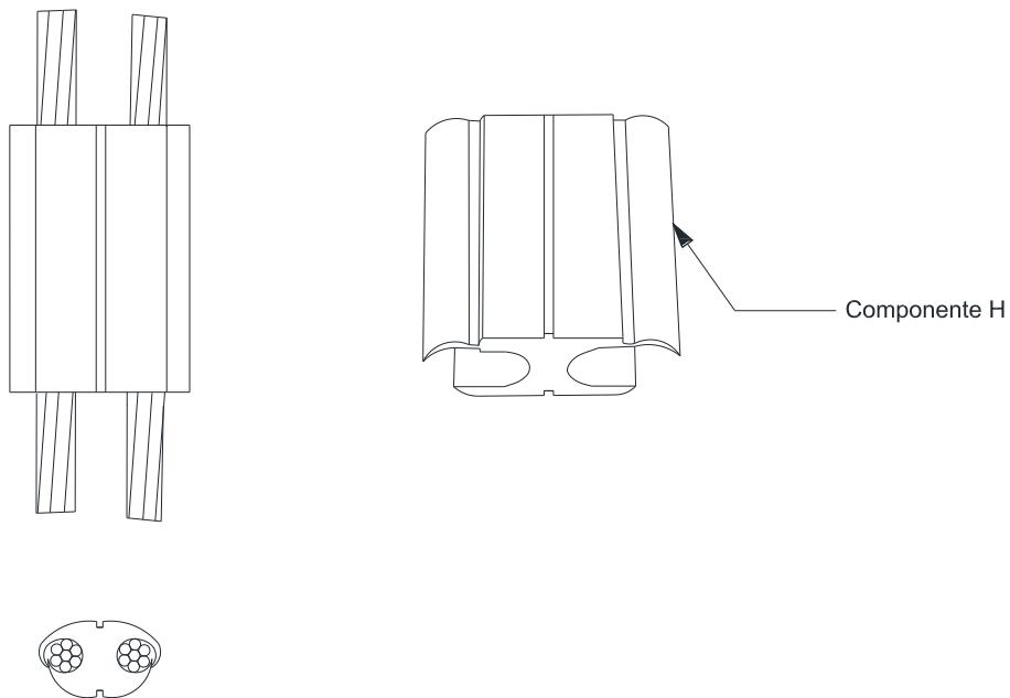
Figura 169 – Conexões – Conector de compressão tipo “H”
