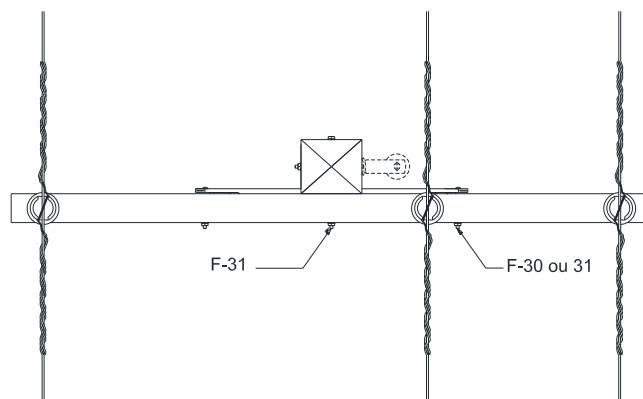
Figura 40 – Estrutura N1 – Poste de concreto de DT ou de madeira
