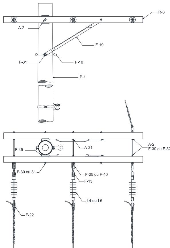
Figura 53 – Estrutura M3 – Poste de concreto de seção circular
