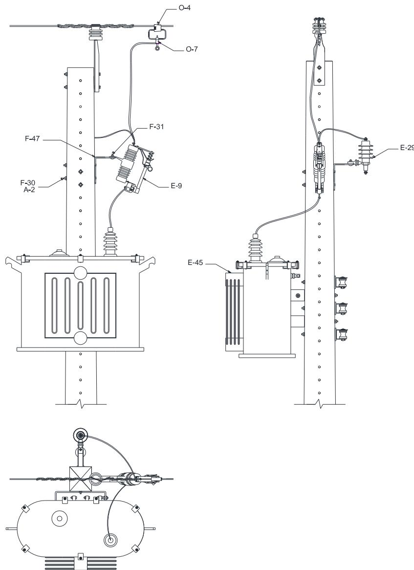
Figura 112 – Instalação de equipamento – Transformador monofásico – Estrutura monofásica
