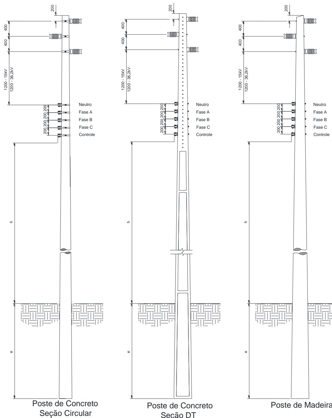
Figura 15 – Afastamentos mínimos – Estrutura pilar trifásica tangente
