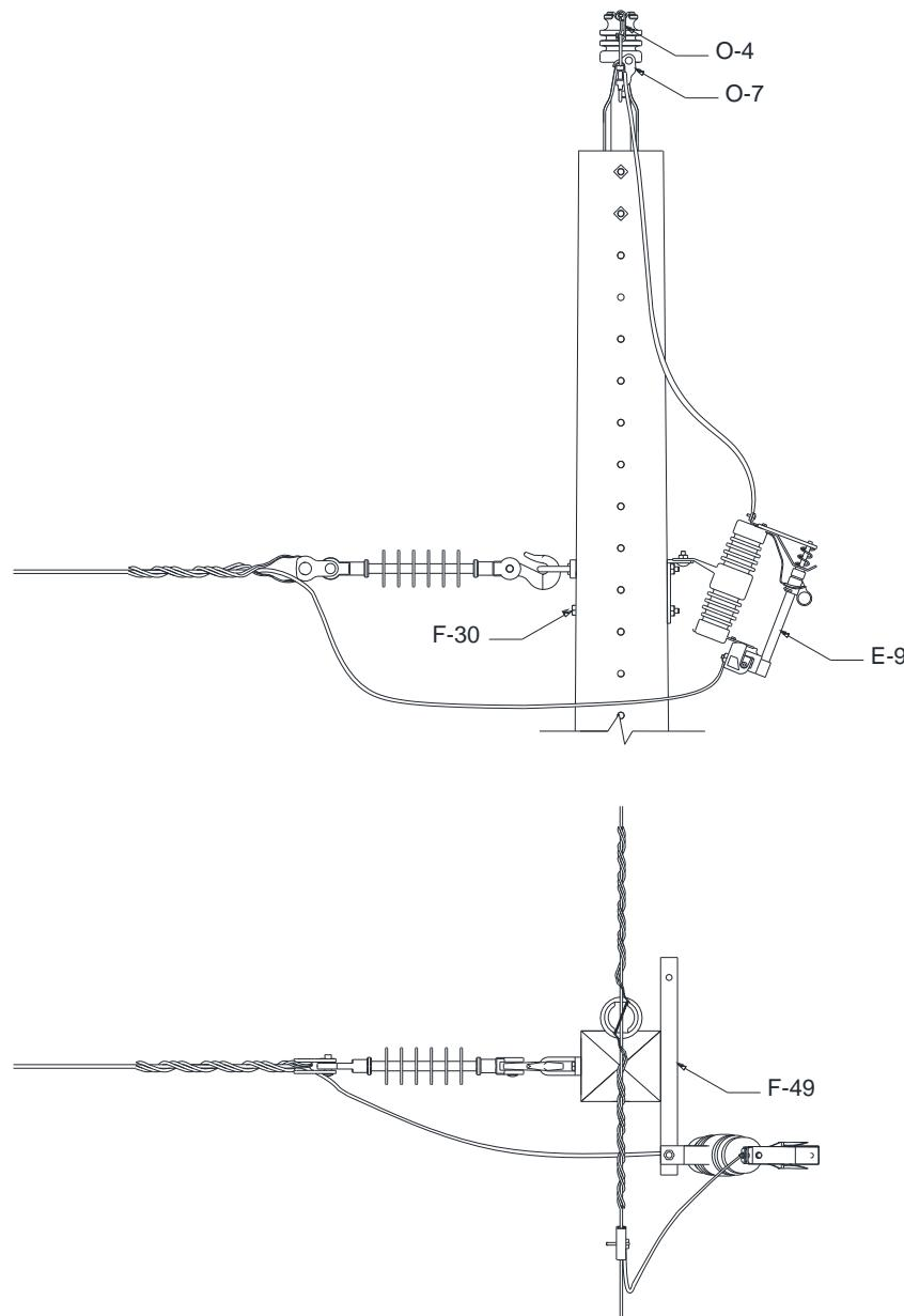
Figura 86 – Instalação de equipamento – Chave fusível em derivação monofásica – Estrutura monofásica – Alternativa
