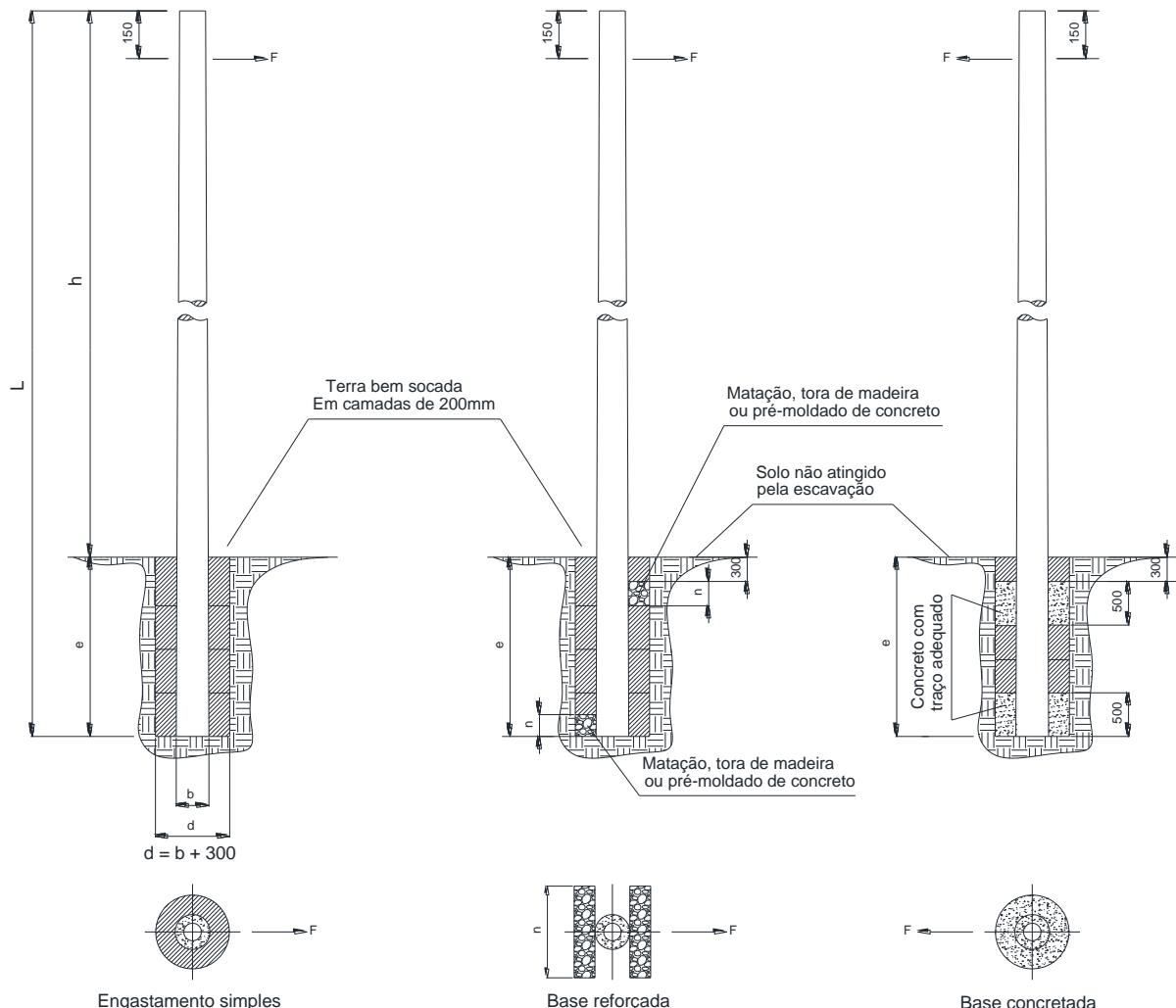
Figura 20 – Engastamento de poste – Detalhe da fundação
