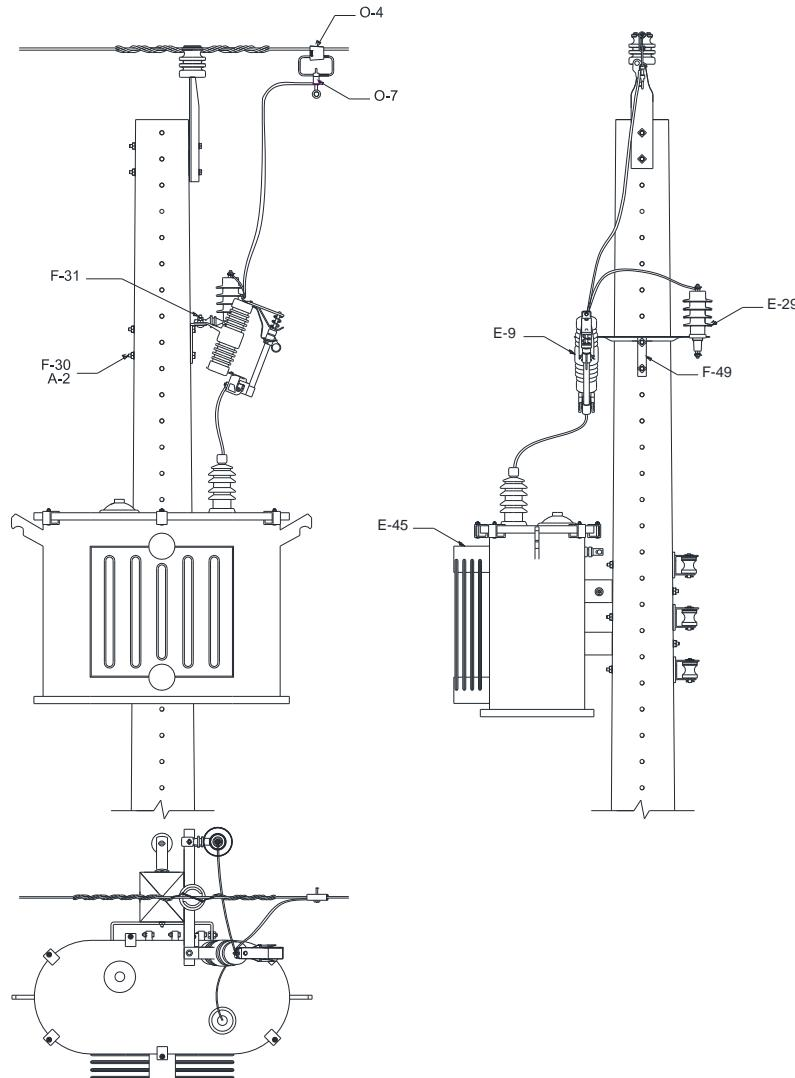
Figura 110 – Instalação de equipamento – Transformador monofásico – Estrutura monofásica
