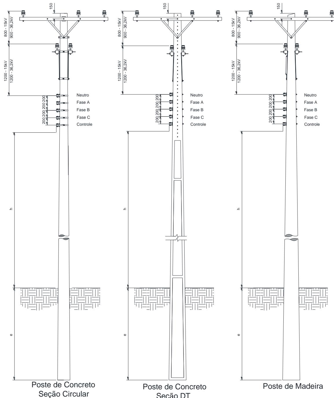
Figura 10 – Afastamentos mínimos – Estruturas trifásicas tangentes com derivações
