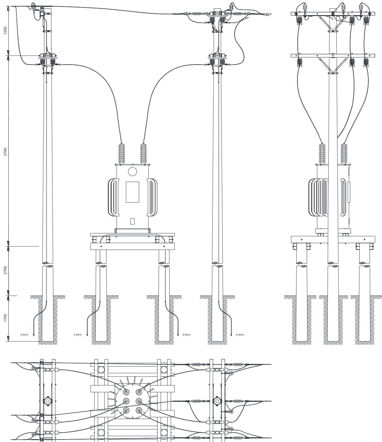
Figura 137 - Instalação de equipamento – Regulador de tensão – Trifásico
