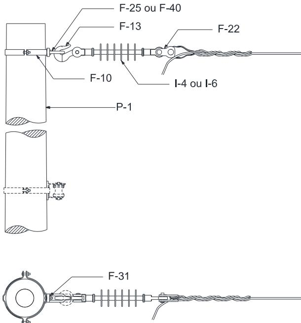
Figura 32 – Estrutura U3 – Poste de concreto de seção circular
