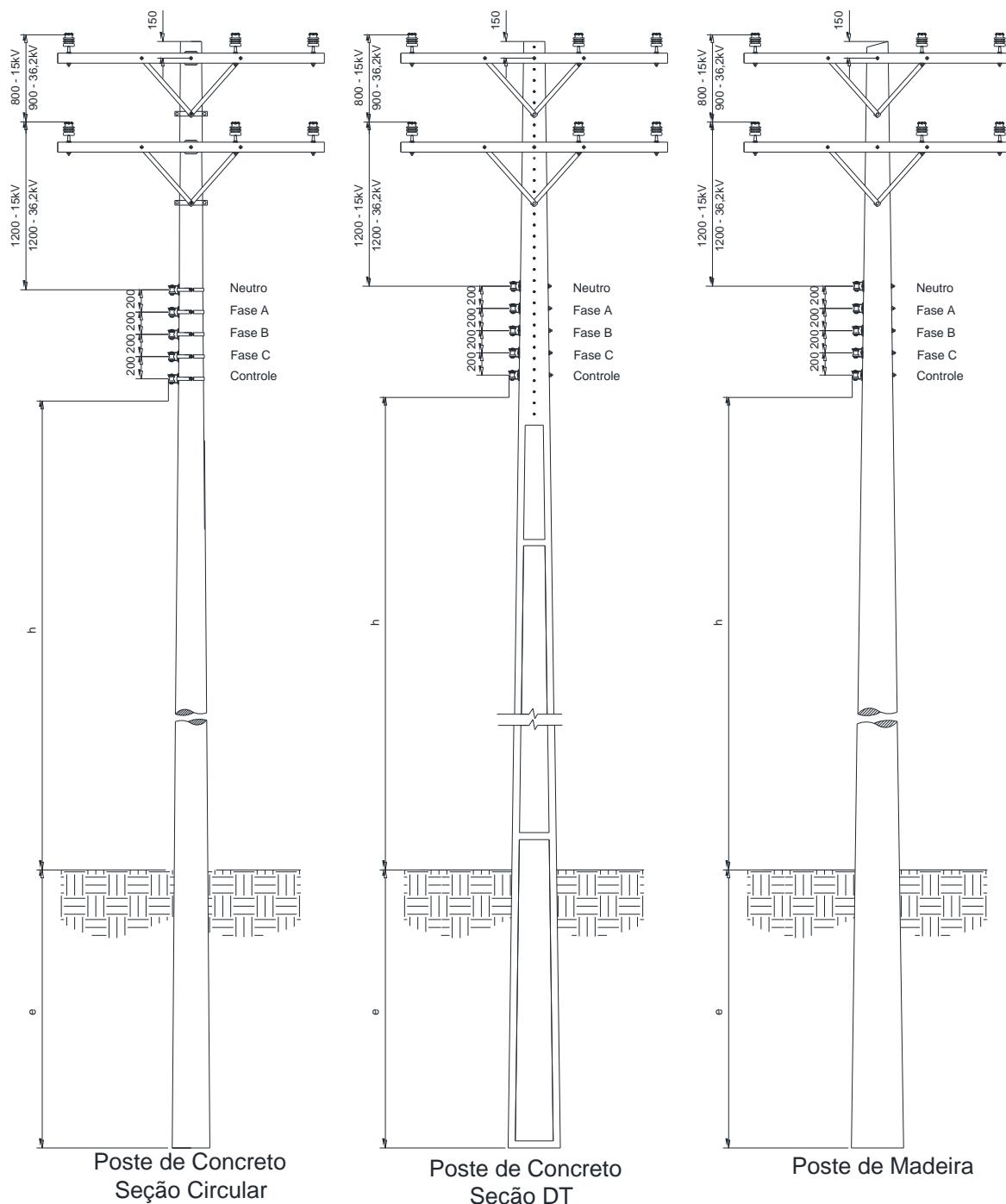
Figura 11 – Afastamentos mínimos – Estructuras trifásicas tangentes
