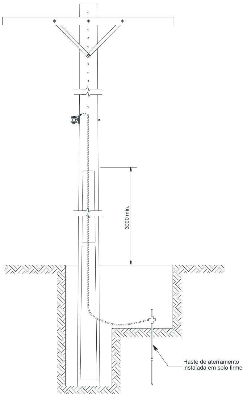
Figura 144 – Aterramento de rede secundária – Poste de concreto
