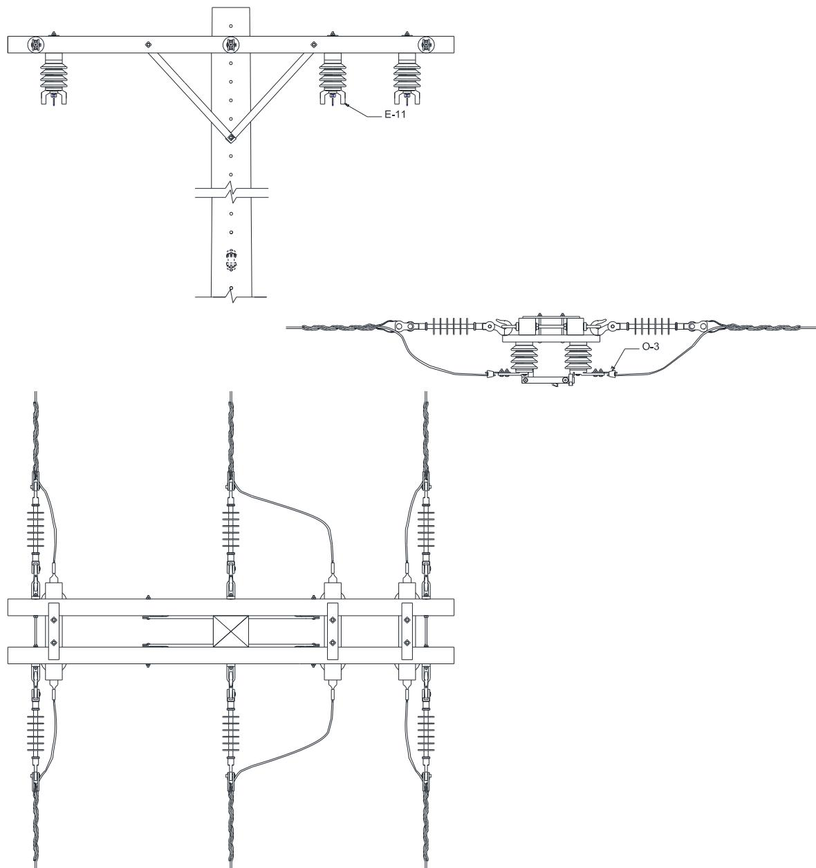
**Figura 97 – Instalação de equipamento – Chave seccionadora 1º nível – Estrutura trifásica N4****NOTAS:**
