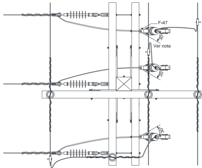
Figura 91 – Instalação de equipamento – Chave fusível em derivação trifásica – Estrutura trifásica
