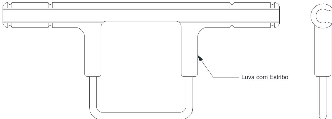
Figura 170 – Conexões – Conector luva estribo
