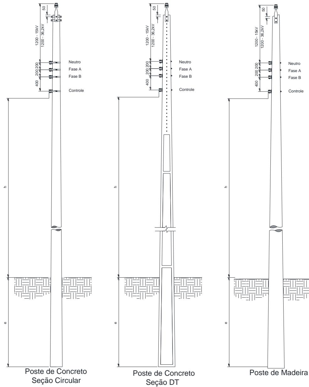
Figura 7 – Afastamentos mínimos – Estrutura monofásica tangente
