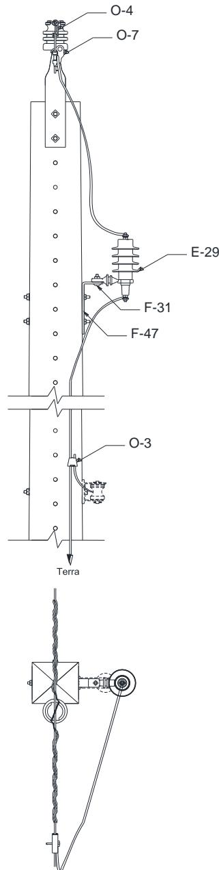
Figura 106 – Instalação de equipamento – Para-raios – Estrutura monofásica – 2º nível – Alternativa
