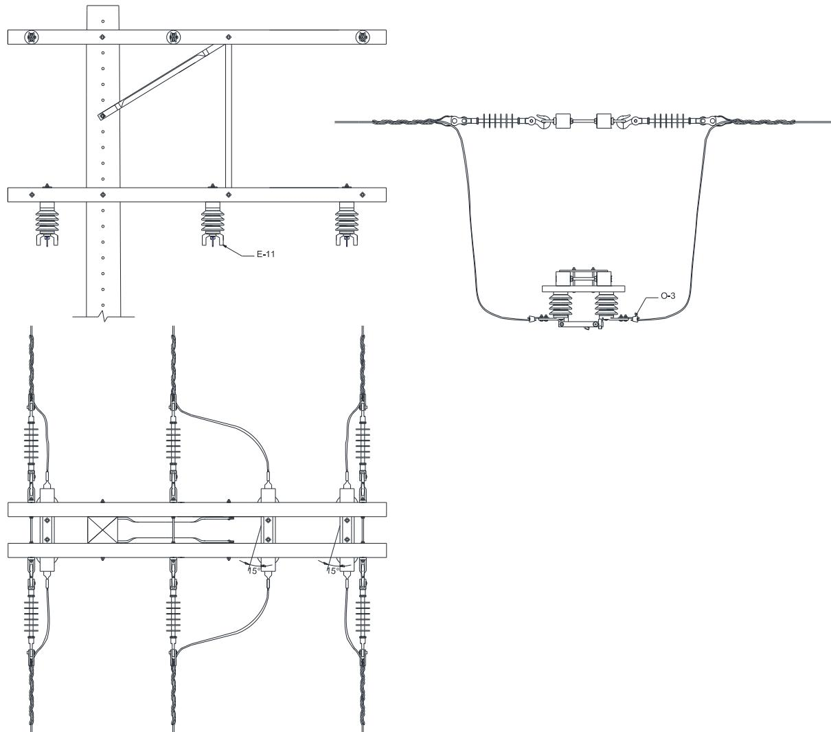
**Figura 100 – Instalação de equipamento – Chave seccionadora 2º nível – Estrutura trifásica M4****NOTA:**
