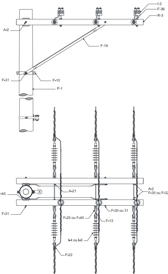
Figura 67 – Estrutura B4 – Poste de concreto de seção circular
