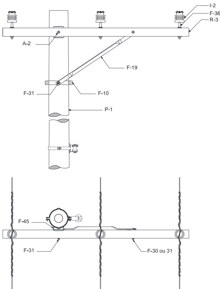
Figura 49 – Estrutura M1 – Poste de concreto de seção circular
