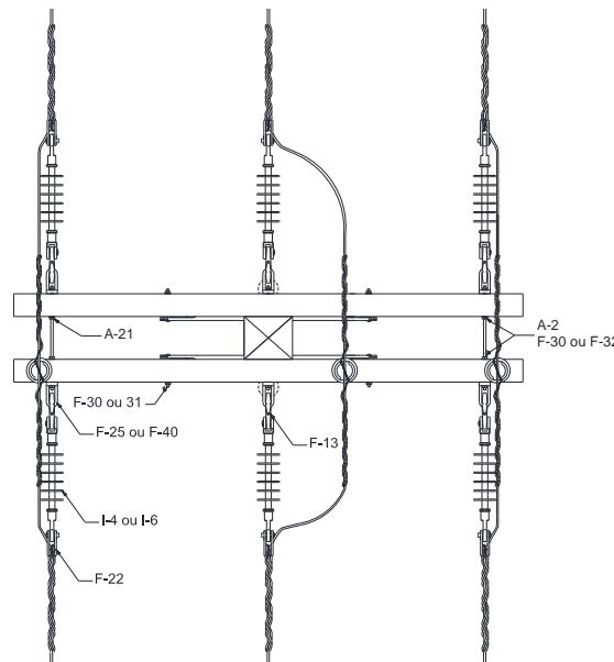
Figura 48 – Estrutura N4 – Poste de concreto de DT ou de madeira
