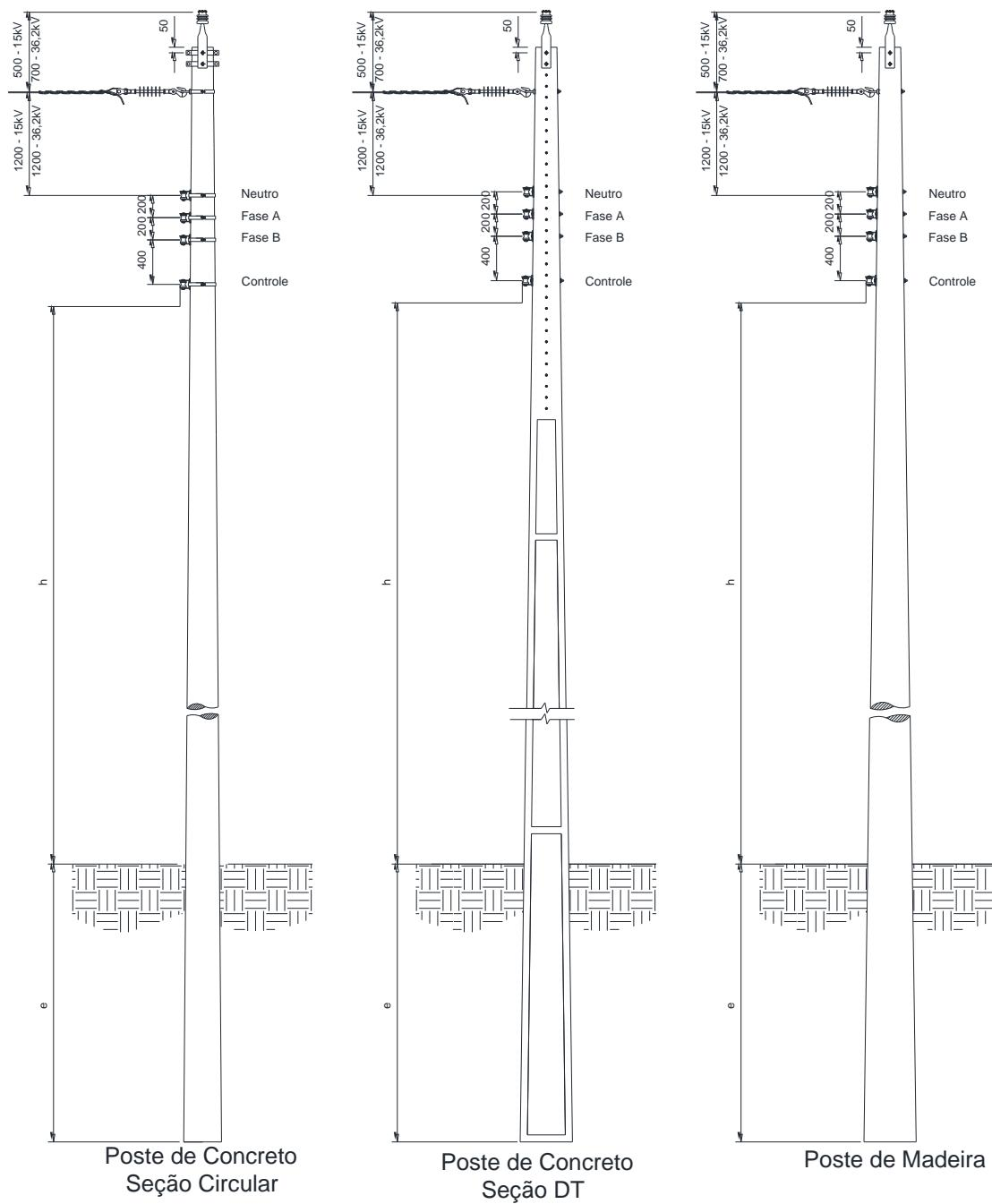
Figura 8 – Afastamentos mínimos – Estrutura monofásica tangente com derivação
