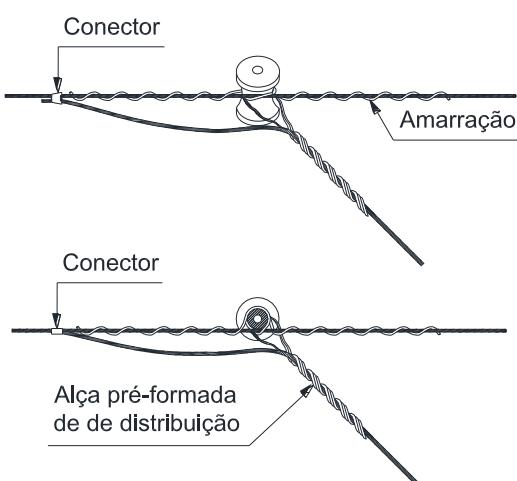
Figura 153 – Amarrações e ligações – Estrutura secundária – Encabeçamento duplo e derivação
