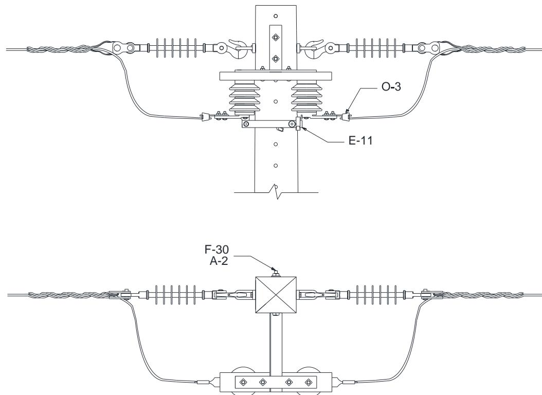
Figura 96 – Instalação de equipamento – Chave seccionadora – Estrutura monofásica
