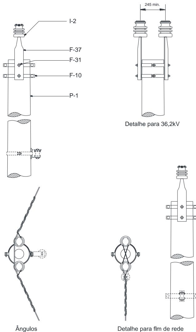
Figura 30 – Estrutura U2 – Poste de concreto de seção circular
