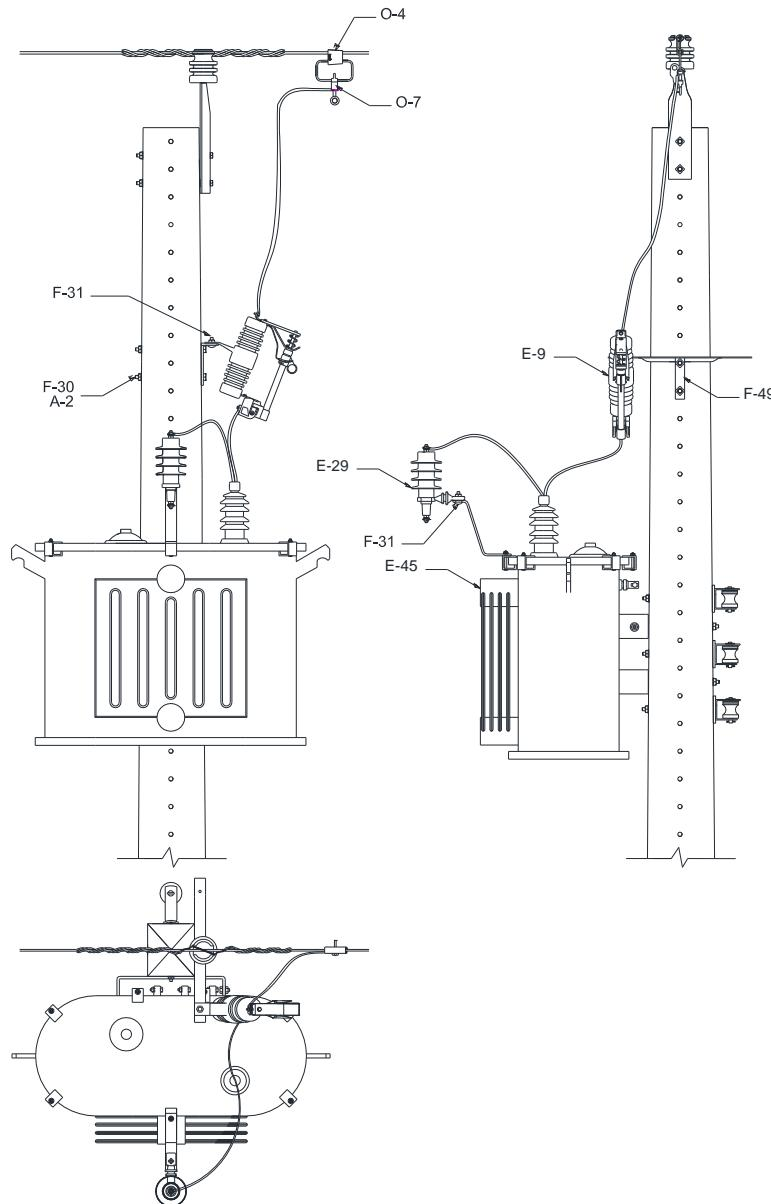
Figura 111 – Instalação de equipamento – Transformador monofásico – Estrutura monofásica
