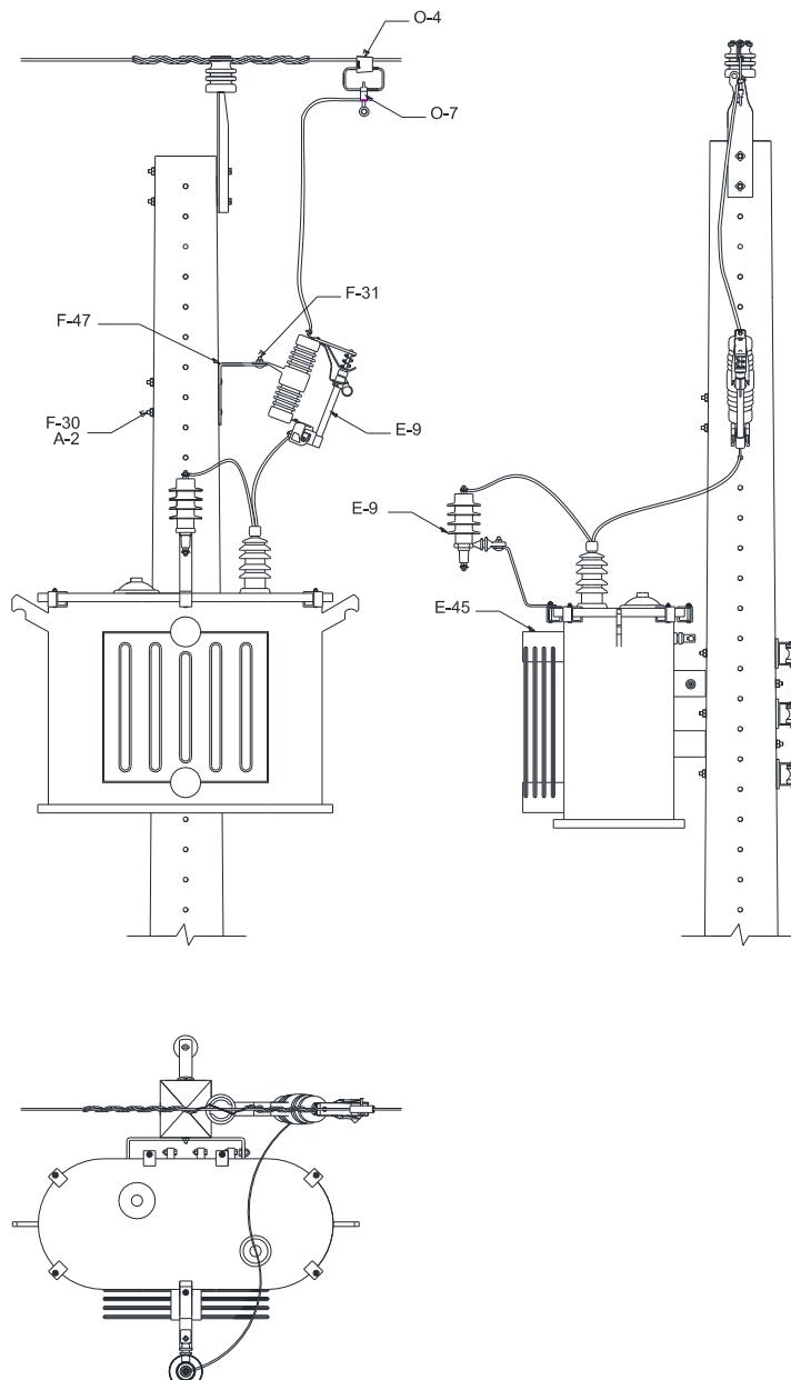
Figura 113 – Instalação de equipamento – Transformador monofásico – Estrutura monofásica
