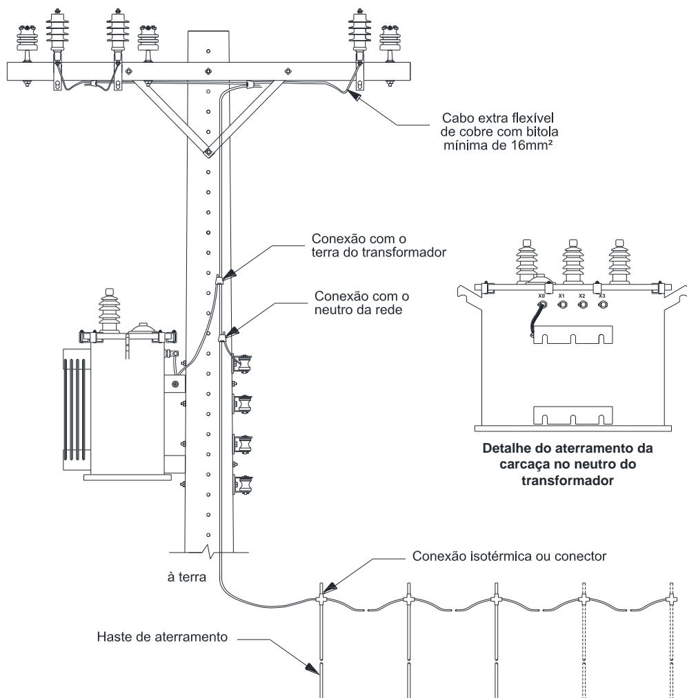
**Figura 142 – Aterramento de equipamento**
