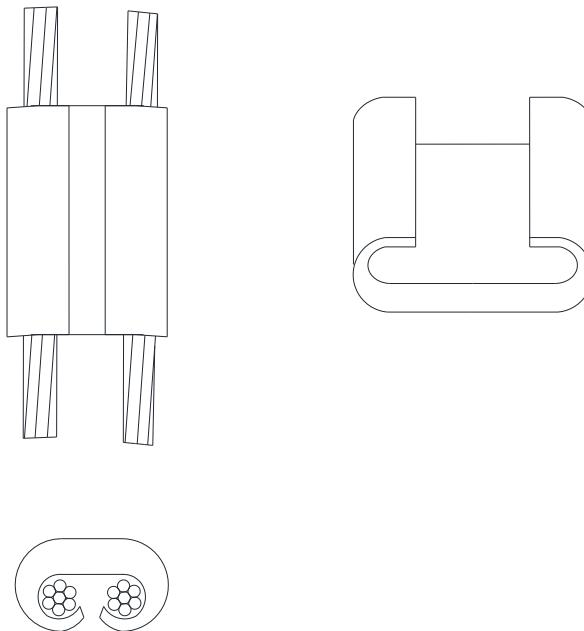
Figura 167 – Conexões – Conector de compressão tipo “C”
