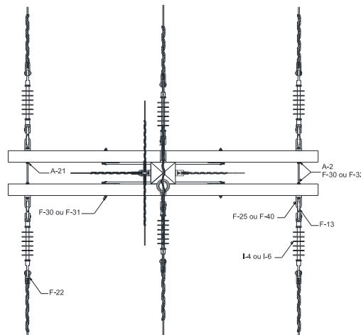
Figura 69 – Estrutura TE – Poste de concreto de DT ou de madeira
