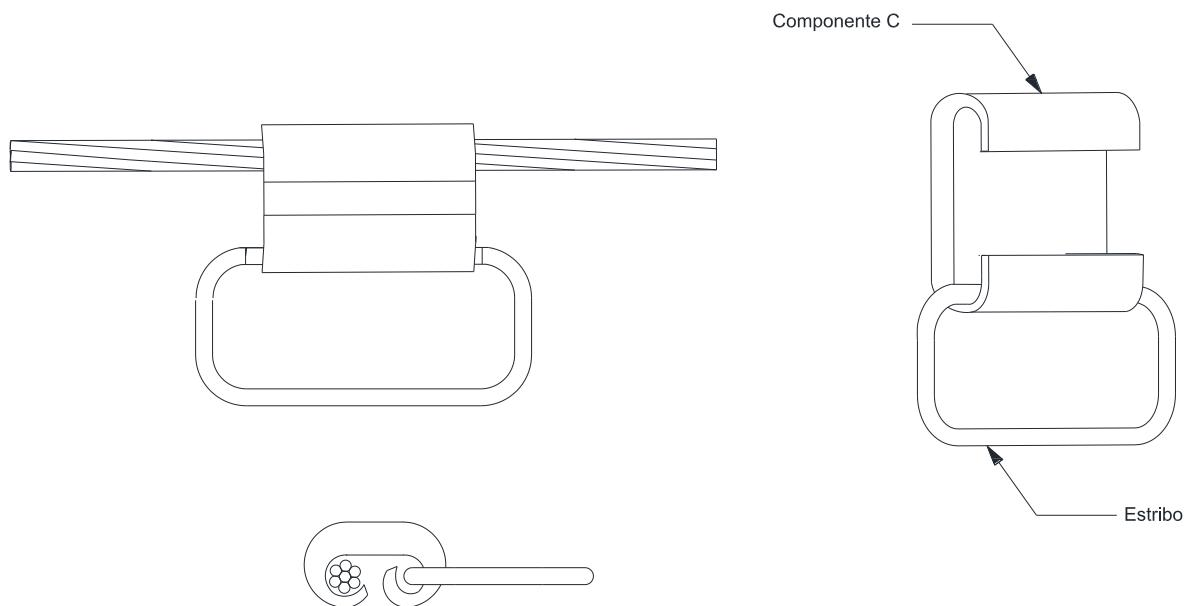
Figura 168 – Conexões – Conector de compressão tipo “C” com estribo
