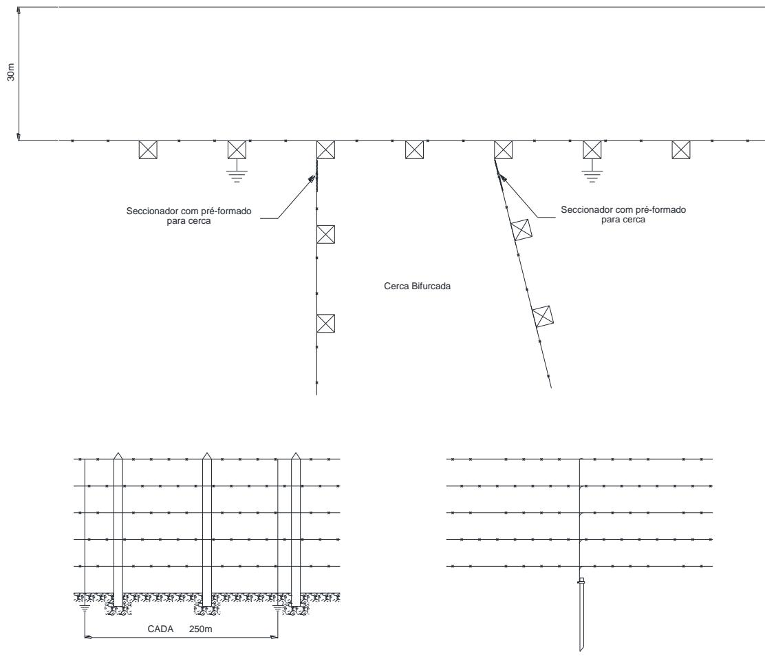
Figura 173 – Seccionamento de cerca – Cercas transversais
