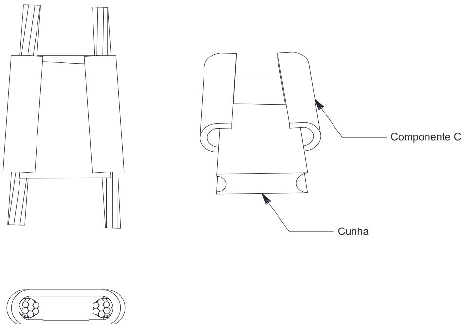
Figura 165 – Conexões – Conector cunha com estribo
