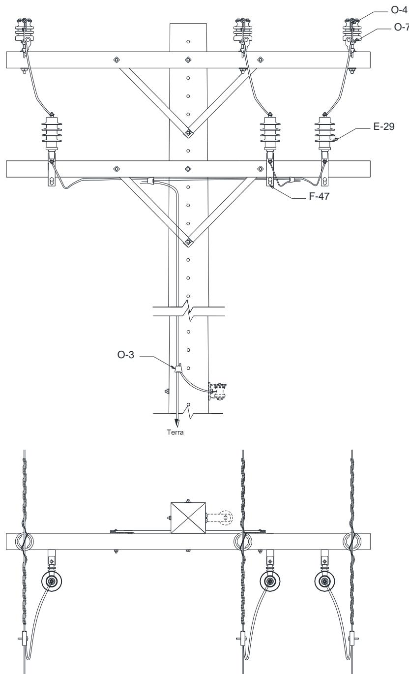
Figura 108 – Instalação de equipamento – Para-raios – Estrutura trifásica - Alternativa
