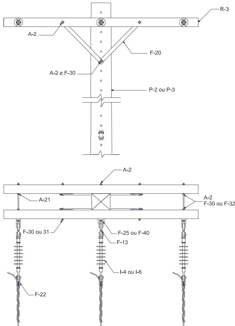
Figura 44 – Estrutura N3 – Poste de concreto de DT ou de madeira
