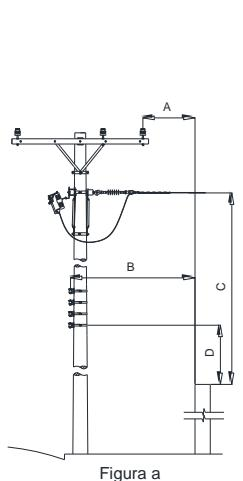
Afastamento horizontal e vertical entre os condutores e o muro
