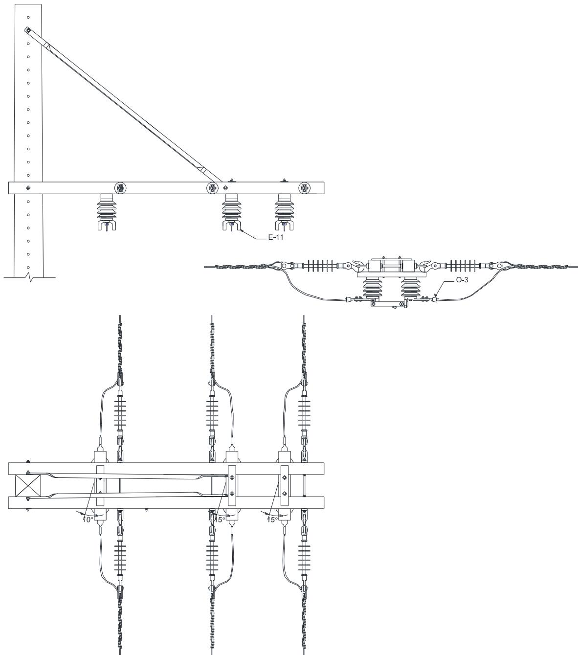
**Figura 102 – Instalação de equipamento – Chave seccionadora – Estrutura trifásica B4****NOTA:**
