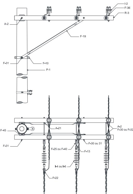
Figura 65 – Estrutura B3-2 – Poste de concreto de seção circular
