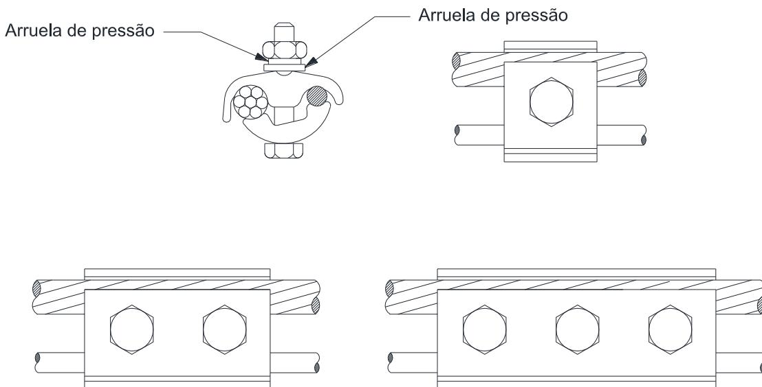
Figura 171 – Conexões – Conector paralelo (1 ou 2 parafusos)
