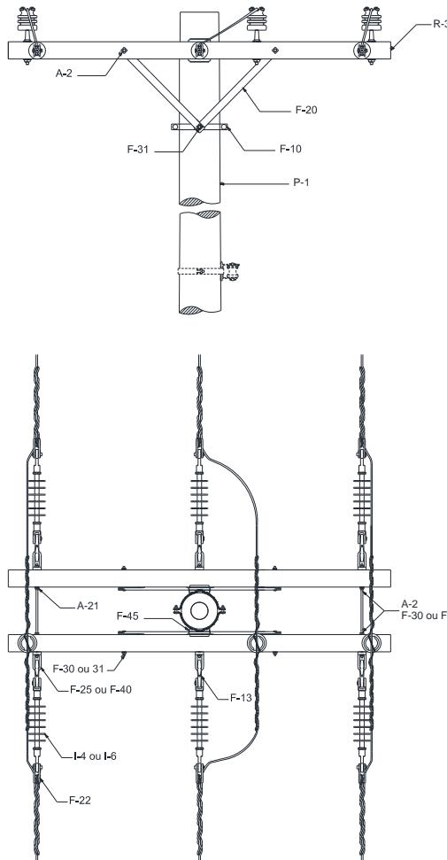
Figura 47 – Estrutura N4 – Poste de concreto de seção circular
