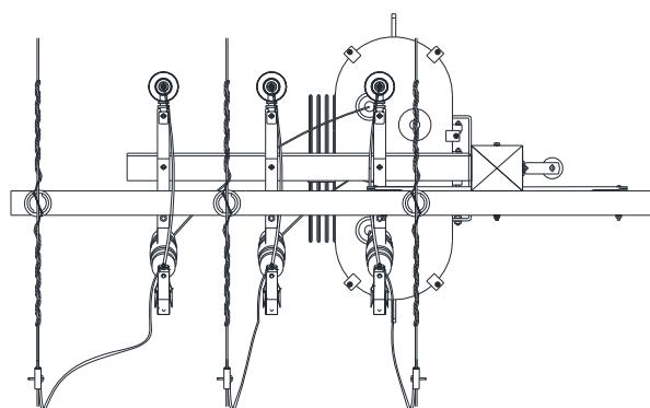
Figura 120 – Instalação de equipamento – Transformador trifásico – Chave fusível e para-raios no 2º nível – Suporte Horizontal
