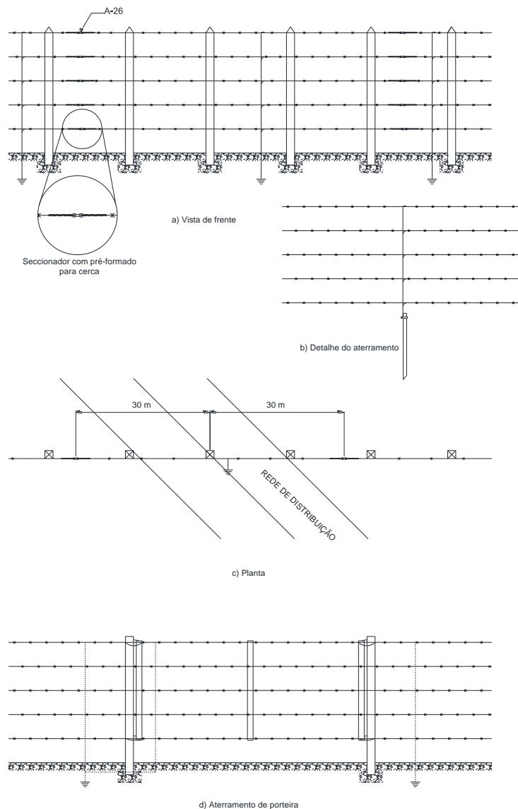
Figura 172 – Seccionamento de cerca – Cerca paralela
