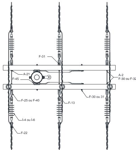
Figura 57 – Estrutura M4 – Poste de concreto de seção circular
