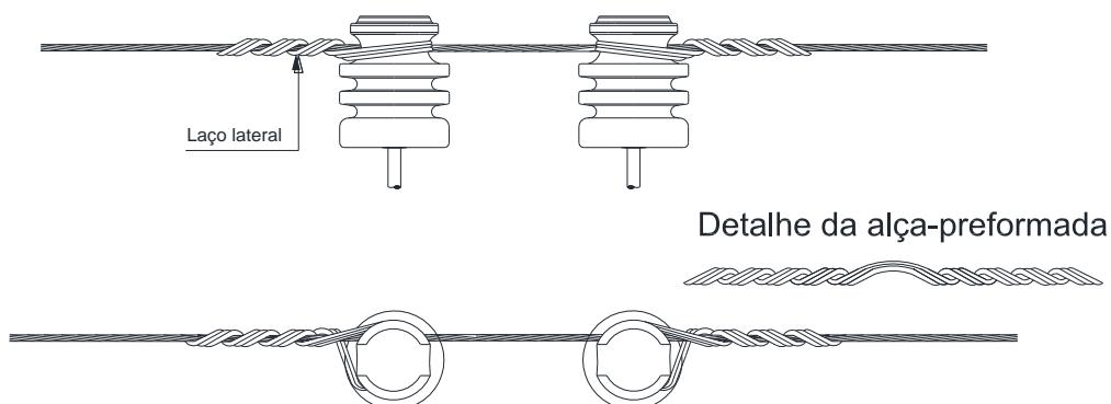
Figura 162 – Amarrações e ligações – Estrutura primária – Amarração lateral com fio e fita
