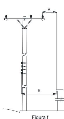
Afastamento horizontal entre os condutores e a cimalha e o telhado de edificações
