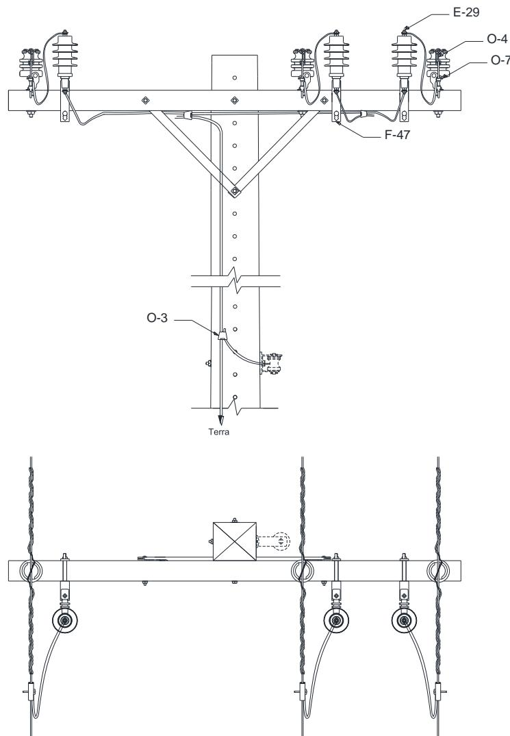
Figura 107 – Instalação de equipamento – Para-raios – Estrutura trifásica
