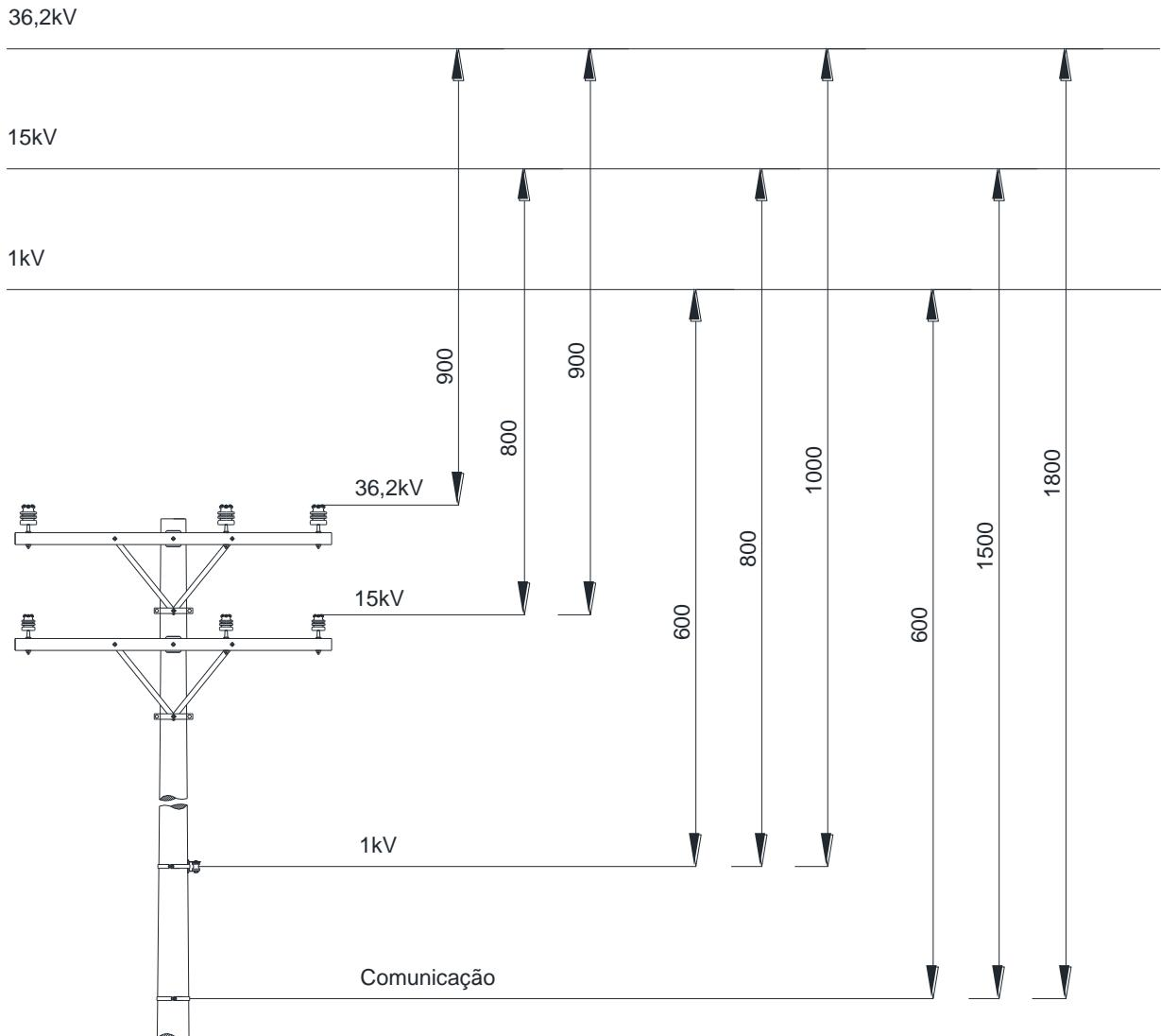
Figura 4 – Afastamentos mínimos – Circuitos diferentes
