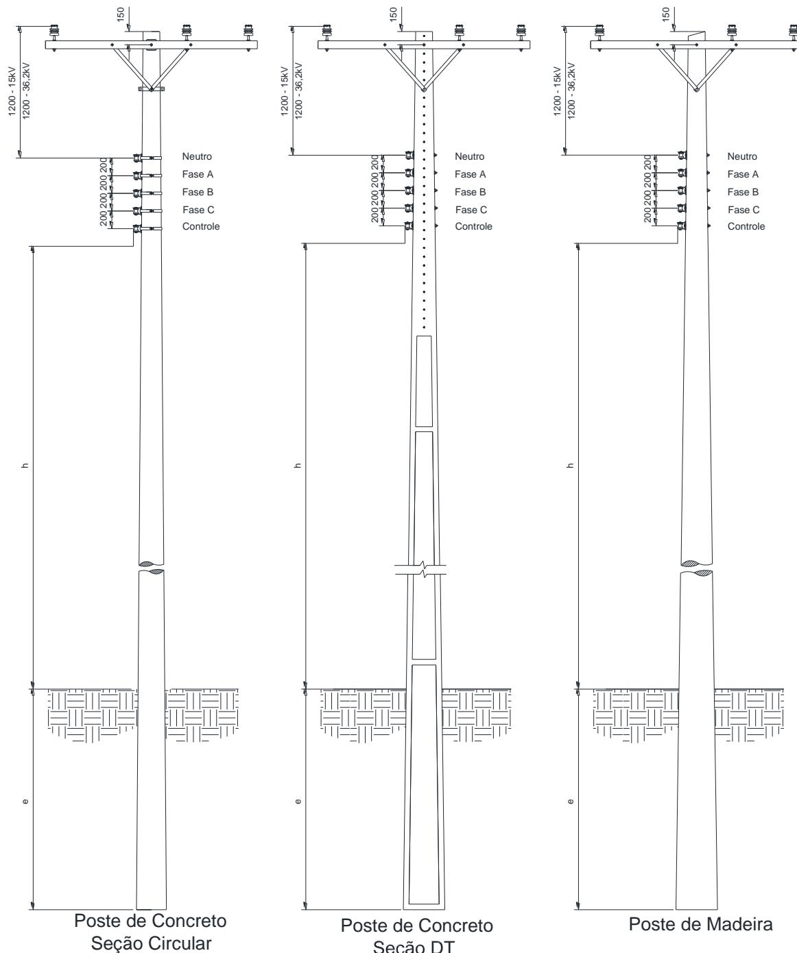
Figura 9 – Afastamentos mínimos – Estruturas trifásicas tangentes
