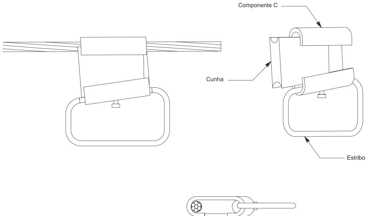
Figura 166 – Conexões – Conector cunha com estribo
