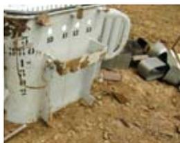
Os ladrões buscam componentes de cobre dos equipamentos, arrancando os condutores do padrão e destruindo os transformadores.
