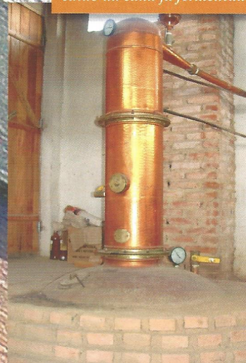
Alambique para destilação do caldo da cana já fermentado
