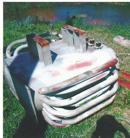
Imagem da carcaça de um transformador que foi roubado. Primeiro o transformador é derrubado e, em seguida, é retirado seu núcleo de cobre
