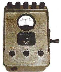
Megômetro (medidor de resistência elétrica) usado nos anos 60
