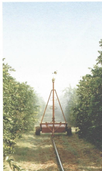
Irrigadora automática: um dos diferenciais para a qualidade da safra do Sítio da Chuva. A bomba, que capta água de uma represa a 1.500m de distância, também é movida a eletricidade
