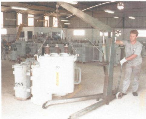
Transformador, no galpão do setor, sendo levado para teste
