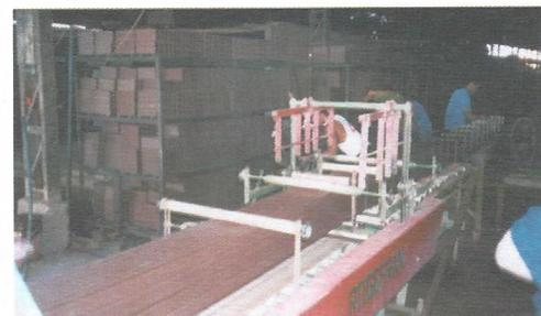
Máquina onde são cortadas as peças de argila, já no formato final, para depois irem para as estufas de secagem
